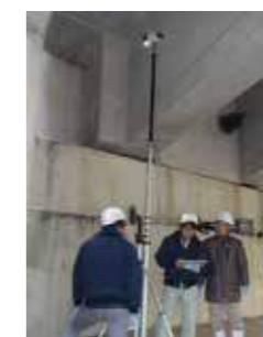
ロボットカメラ(高所型)を用いた桁端部のモニタリング状況
