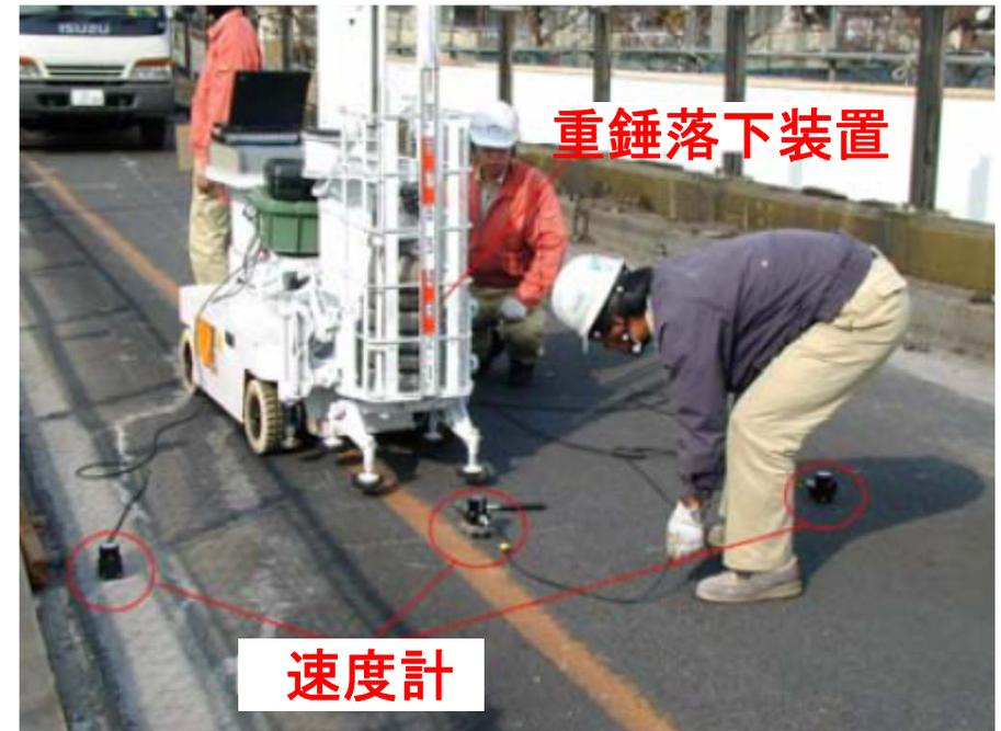
衝撃荷重載荷法を用いた舗装・RC床版の健全度評価
