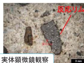
本橋は平成10年、現在のASR抑制対策後に建設され、骨材の周りにASRによる反応リムが見られた。
