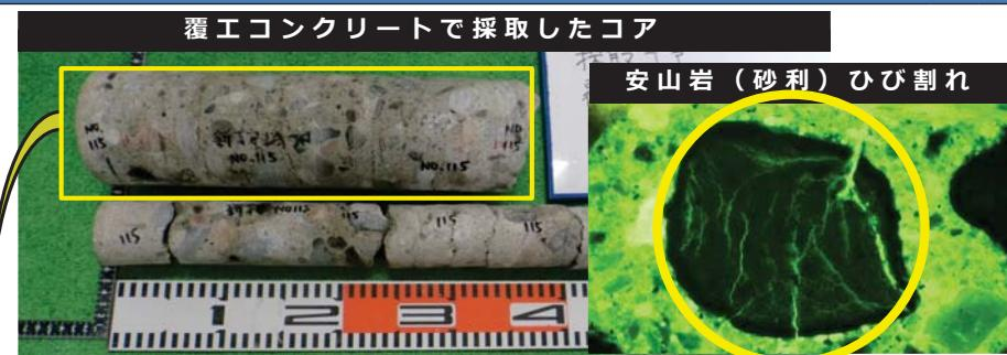
覆工コンクリート断面内部に生じた輪切り状のひび割れ
