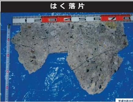
冬期、横断目地付近で、漏水の凍結によりASRに起因するひび割れから、はく落したと推察された。
