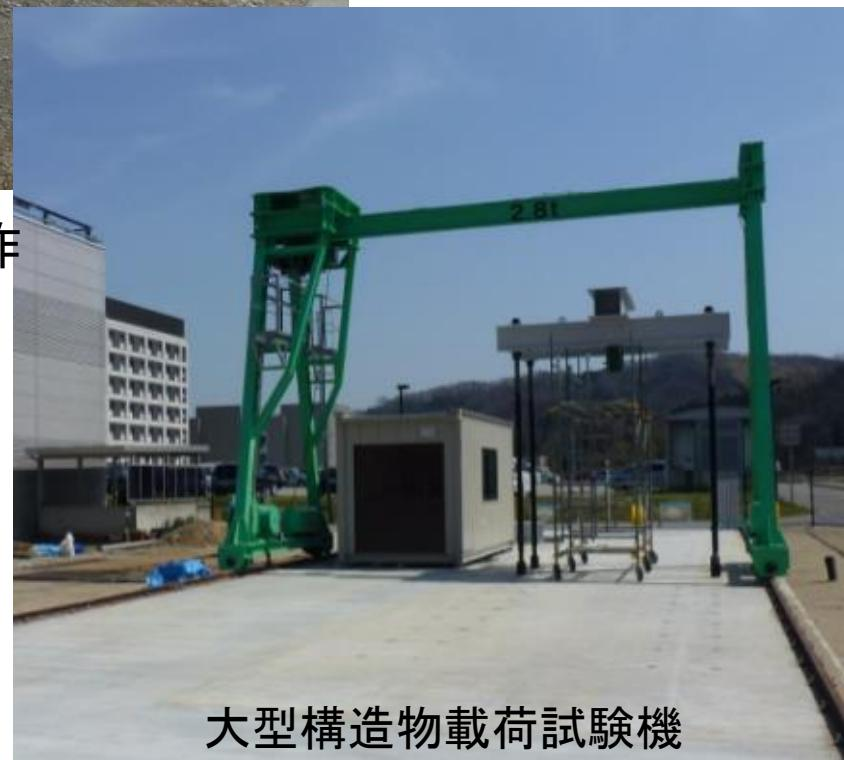
大型構造物載荷試験機
