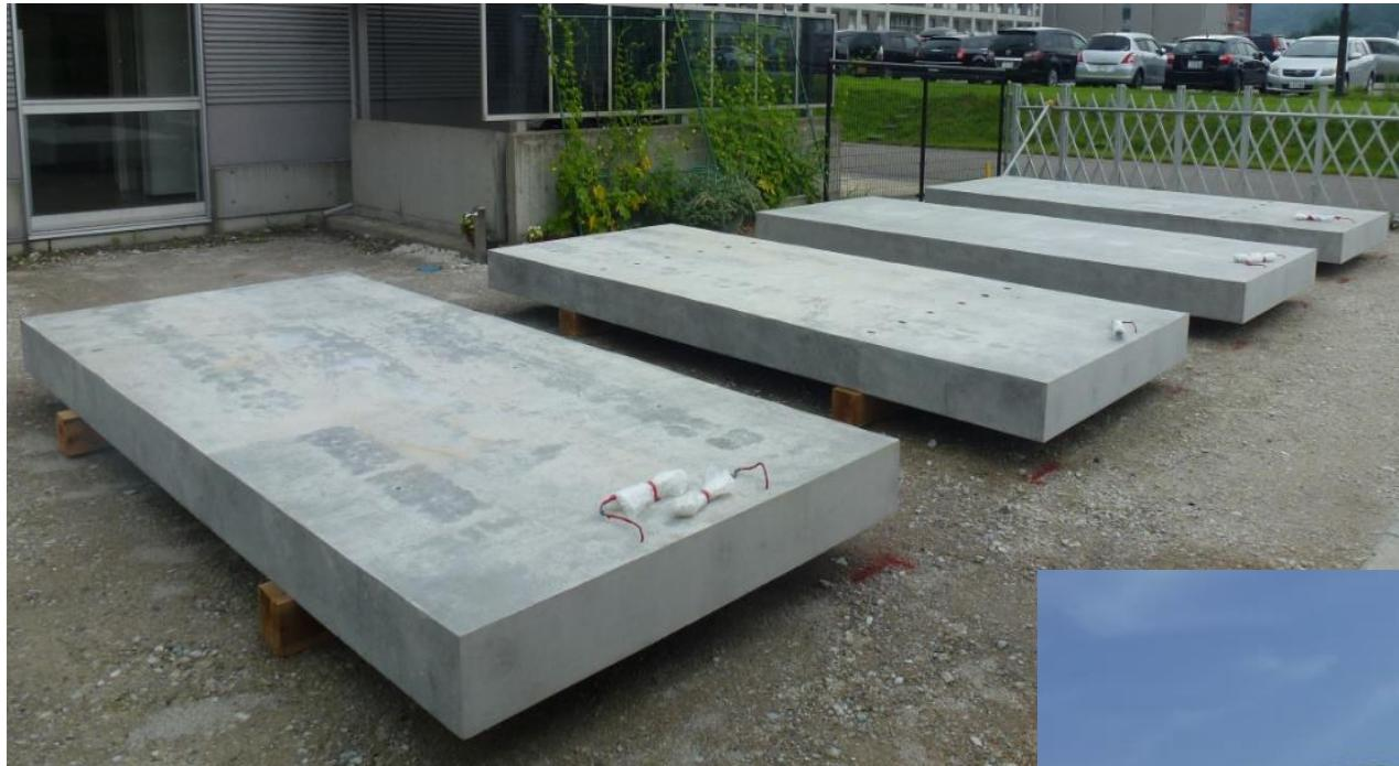
FAコンクリートを用いたPCa・PC床版の製作
