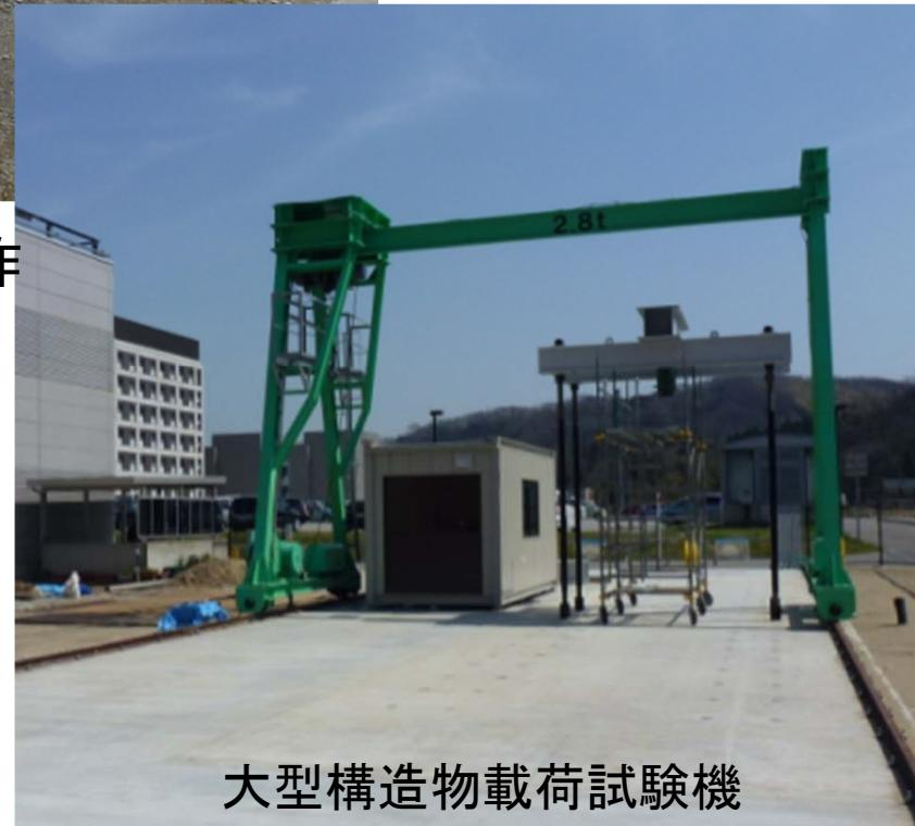
大型構造物載荷試験機
