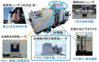
MIMM-R(カメラ、レーザー、空洞レーダー)に内部欠陥レーダーも搭載
