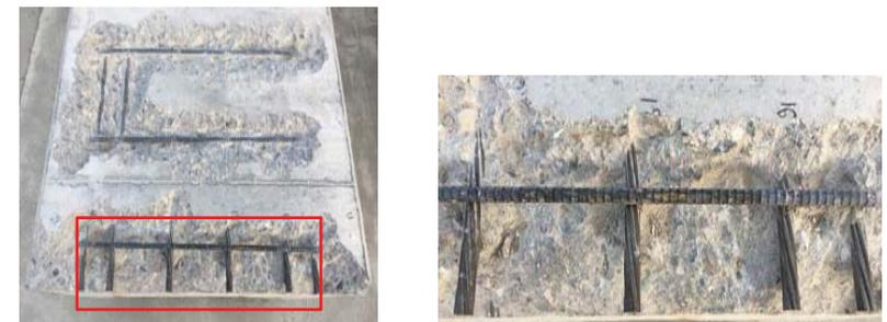
スターラップでわずかに錆が確認されたがPC鋼材はほとんど腐食しておらず、鋼材の断面減少は確認されなかった
