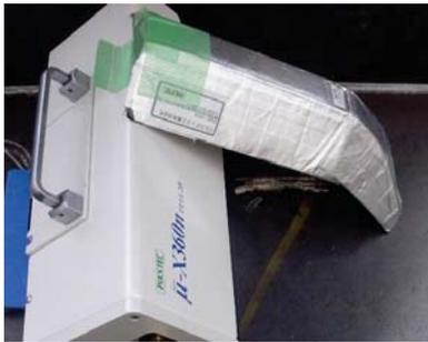
超音波非破壊探傷装置による探傷
